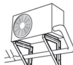
クーラーユニット支持台取り付け
